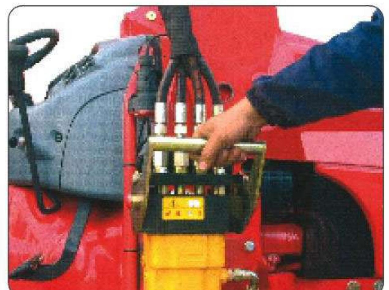
**Multi Kaplin Seçeneği:** Multi kaplin ile 4 adet hidrolik devrenin tek bir el hareketi ile sökülp - takılmasını sağlar. Hızlı ve kolay bağlantı yapmanızı sağlar. Hidrolik devrenin sökülp - takılması esnasında yağsızdır.
