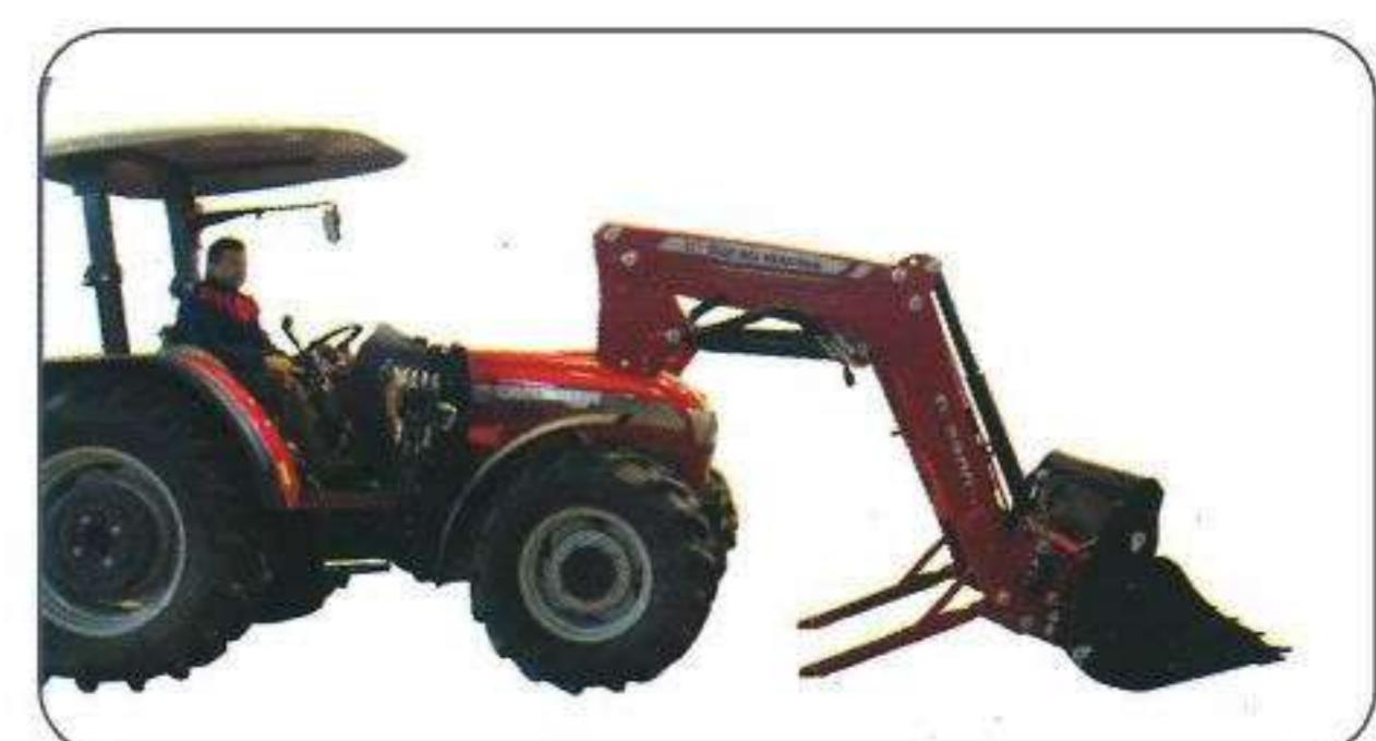
**1** Ön yükleyici üzerindeki park destekleri, kolay ve aletsiz bir şekilde yuvasından çıkartılıp basitçe sabitlenir. Emniyet pernosu çıkarılarak, ön Yükleyicinizi park destekleri üzerinde zemine indirirsınız.
